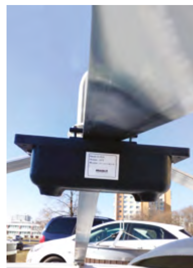
Příklad uchycení senzoru na kontejneru
